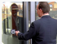
Zutrittskontrolle mit abgesetztem Leser am PZE-Master. Access control with external reader at PZE-Master.
